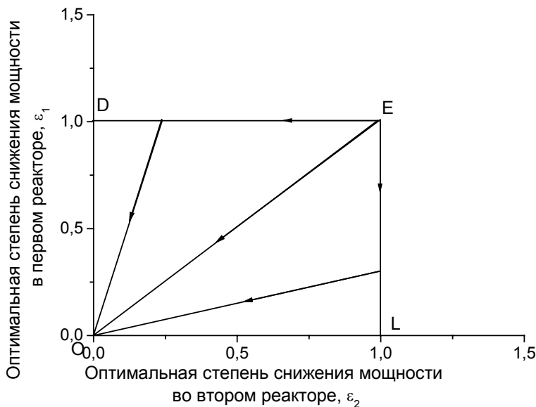
Рис. 4.9. Траектории оптимальных степеней снижения мощностей в системе двух реакторов с нелинейной зависимостью \varepsilon(\Delta p)
