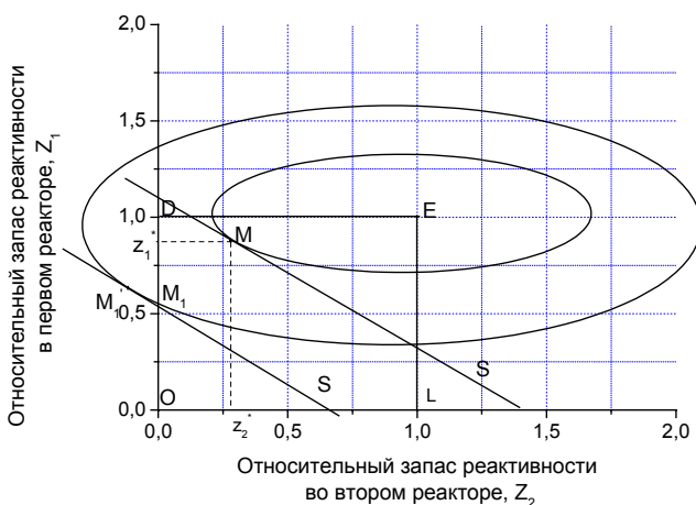
Рис. 4.7. Решение оптимизационной задачи для системы двух реакторов с нелинейной зависимостью степени снижения мощности от запаса реактивности
