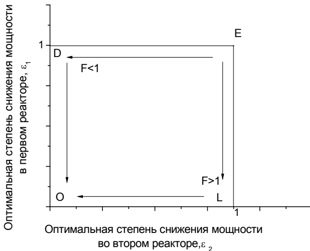
Рис. 2.3. Траектории оптимальных степеней снижения мощности в системе двух реакторов с низким потоком (линейная зависимость \varepsilon(\Delta p) )
