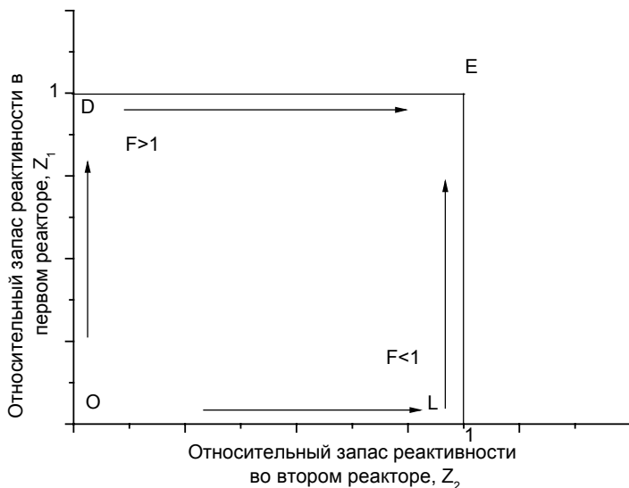
Рис. 2.2. Траектории оптимальных распределений относительных запасов реактивности в системе двух реакторов с низким потоком (линейная зависимость \varepsilon(\Delta\rho) )
